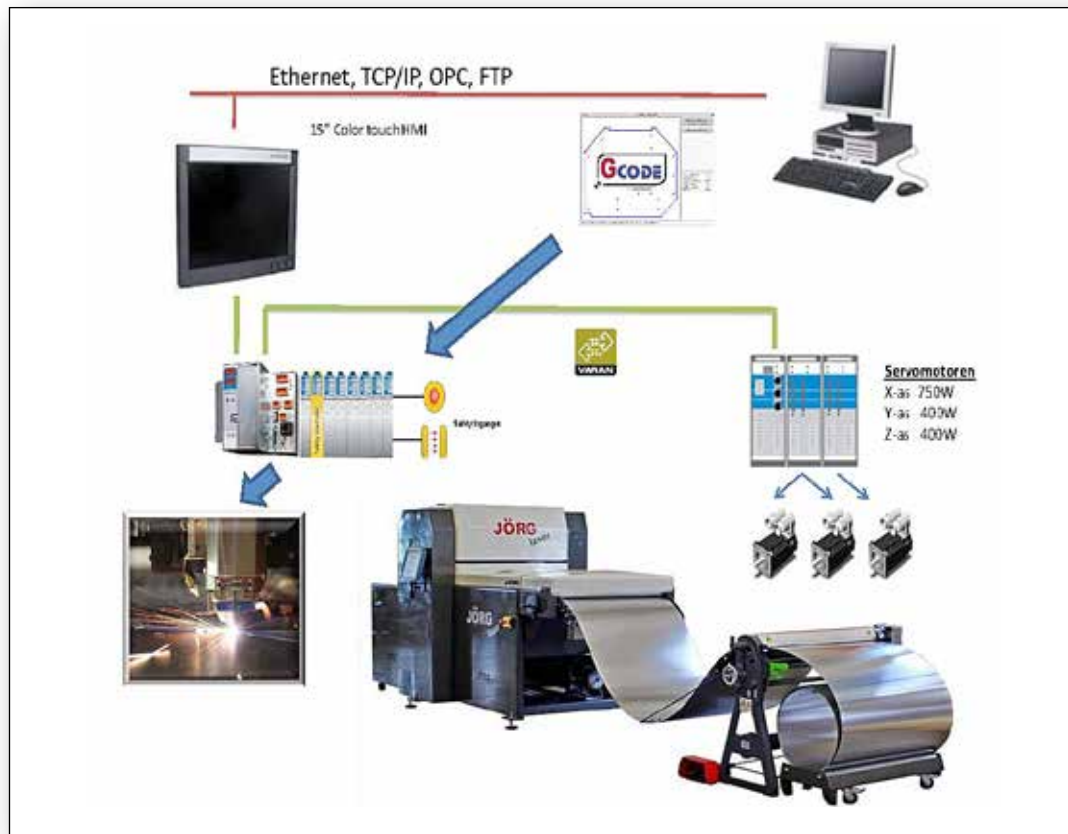
De besturingstopologie van de nieuwe lasersnijmachine
