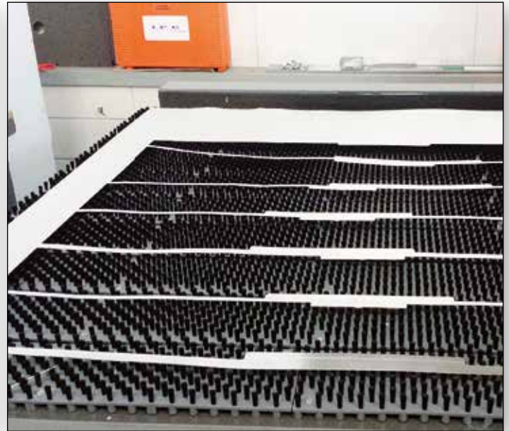
Op mechanisch vlak kan als grootste vernieuwing het zogenoemde 'borstelbed' worden aangestipt.
